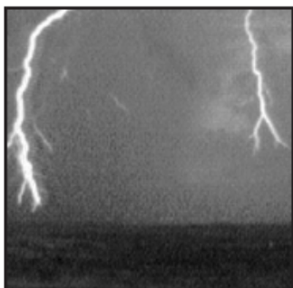
Два одновременных нисходящих ступенчатых лидера (из видеоматериалов НИИ Гидро, Квебек)
